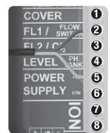
Průtokové čidlo FL1 2 a 5
